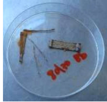
Fibre corrodibili, prova non superata
