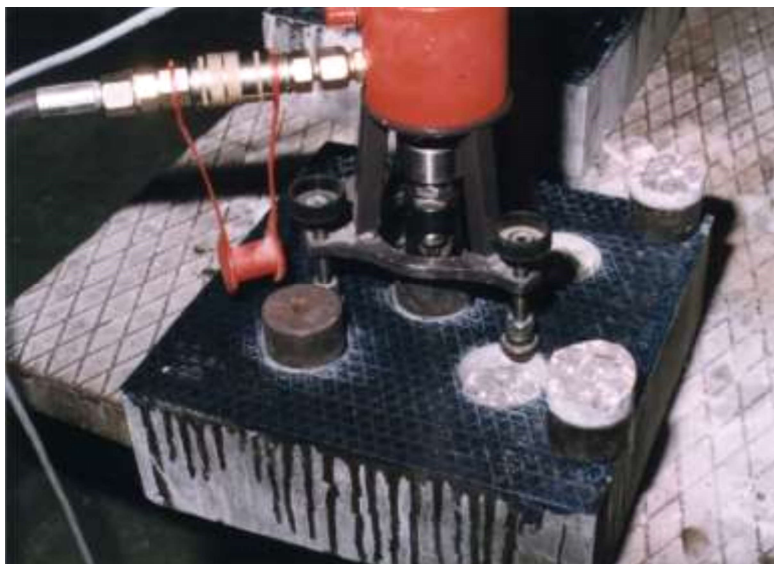
Esecuzione del test secondo UNI EN 1542
