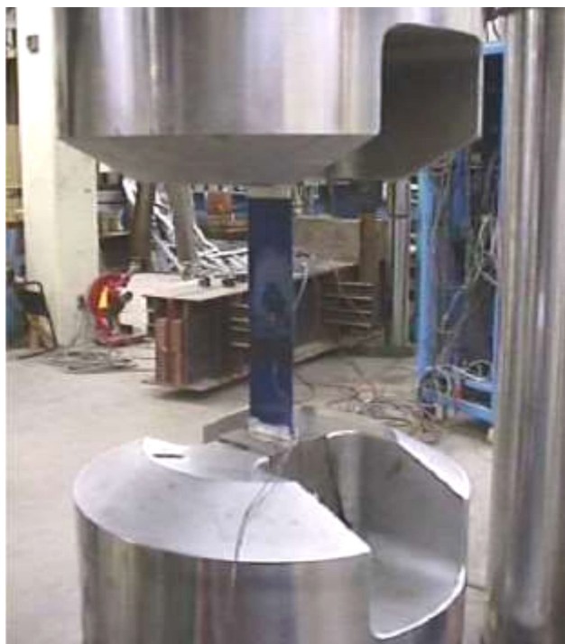
Esecuzione del test secondo ASTM D3039
